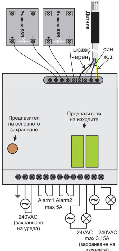
Вариантър за свързване с използване на общо захранване за уреда и консуматорите
