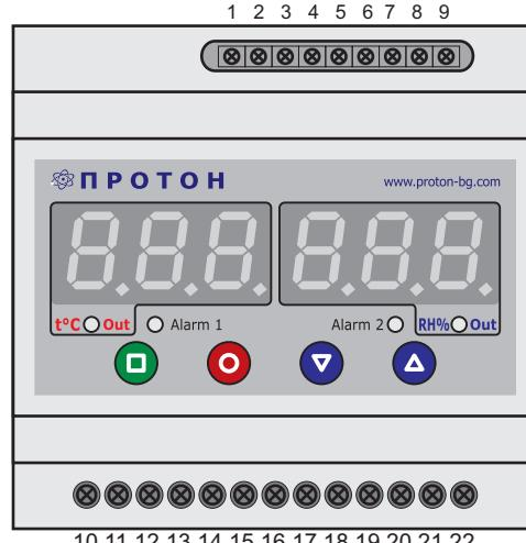
Изходите могат да работят и в режим охлаждане/изсушаване (включен при температура/влажност над зададената). Ако уредът се използва за контрол на температурата в хладилна камера, е задължително изход 1 да бъде включен на позиционен закон за управление, с достатъчно голям хистерезис на превключване и при нужда, увеличаване времето **rdL**, с цел избягване честото включване и изключване на компресора.
